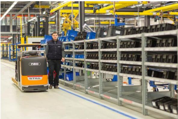
Bild 4: Mit dem autonom agierenden STILL iGo neo CX 20 und dem intelligenten Würth iSHELF werden alle überflüssigen Arbeitsschritte vermieden und die Logistikprozesse im STILL Werk optimiert.
