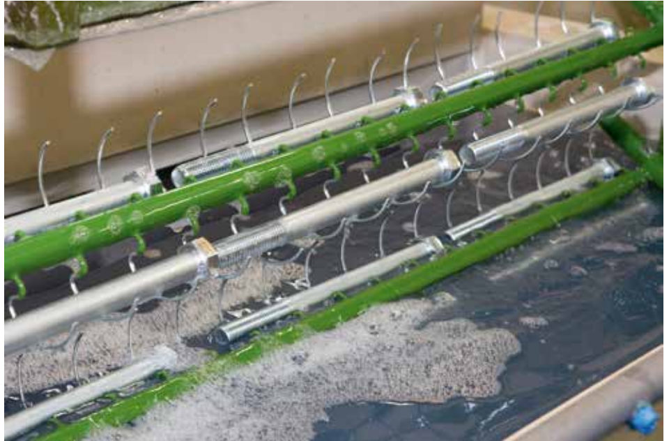
Verzinkung mittels eines Gestells
