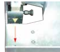
Markierungen auf der Bodenplatte zum Anvisieren des Setzpunktes
